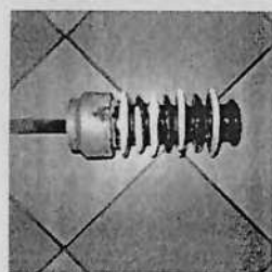
Rys.4. Pęknięcie izolatora między częścią porcelanową a okuciem (a), przebiecie łukiem elektrycznym (b)
