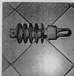
Rys.4. Pęknięcie izolatora między częścią porcelanową a okuciem (a), przebiecie łukiem elektrycznym (b)
