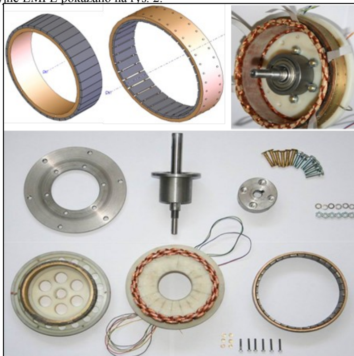
Rys. 2. Elementy konstrukcyjne EMPE
