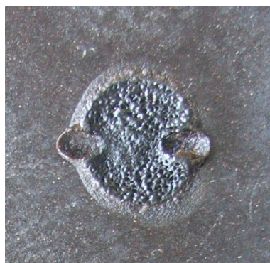
Rys. 3. Przykładowy wykres wytrzymałości na rozciąganie(a) i przykładowy ślad po badaniu odporności na łuk elektryczny (b) kompozycji recyklatowej PE modyfikowanej woskiem poliolefinowym w funkcji czasu działania WGS
