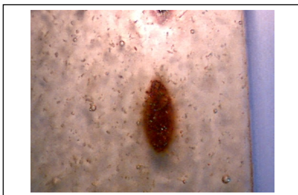
Rys. 12. Powiększenie śladu po badaniu odporności na łuk elektryczny kompozycji epoksydowej z dodatkiem 2,0 g bezwodnika
