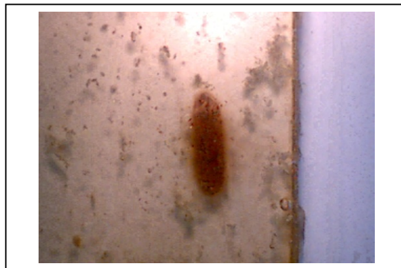
Rys. 9. Powiększenie śladu po badaniu odporności na łuk elektryczny kompozycji epoksydowej z dodatkiem 0,5 g bezwodnika
