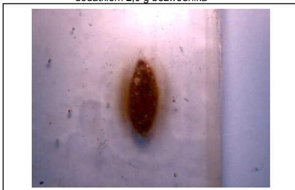
Rys. 13. Powiększenie śladu po badaniu odporności na łuk elektryczny kompozycji epoksydowej bez dodatku bezwodnika
