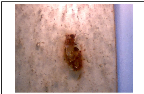
Rys. 11. Powiększenie śladu po badaniu odporności na łuk elektryczny kompozycji epoksydowej z dodatkiem 1,5 g bezwodnika
