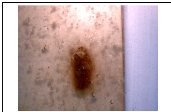
Rys. 10. Powiększenie śladu po badaniu odporności na łuk elektryczny kompozycji epoksydowej z dodatkiem 1,0 g bezwodnika
