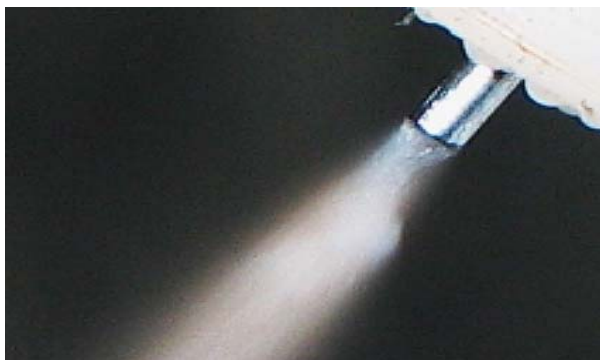
Rys.1. Fotografia końca kapilary przewodzącej ciecz w warunkach przepływu powietrza wokół niej z prędkością naddźwiękową. Widoczny stożek rozpraszanej cieczy
