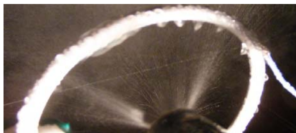
Rys.8. Strumień cieczy rozproszonej przy napięciu polaryzacji +18kV dla rozpylacza wirowego.
