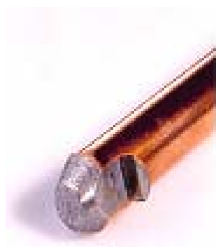
Fot. 1 Widok uziomu pomiedziowanego firmy Galmar po badaniu przyczepności powłoki
