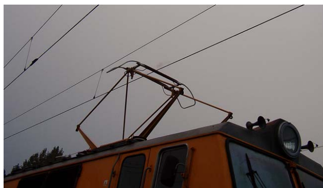
Fot. 1 Pantograf lokomotywy z próbnym ślizgaczem węglowym
