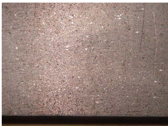
Fot. 3. Wygląd powierzchni ślizgowej nakładki węglowej
