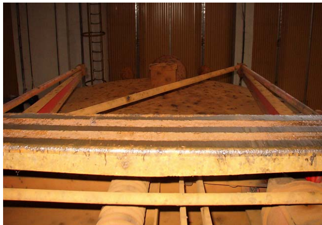
Fot. 2. Wygląd ślizgacza pantografu z nakładkami miedzianymi
