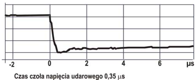
Rys. 6. Kształt napięcia doprowadzonego do badanego przewodu
