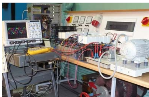
Rys. 8 Widok stanowiska do badań eksperymentalnych układu napędowego z MRPC
