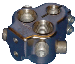
Zacisk TOGA 3: Mocowanie kabli pionowe Zakres przekrojów przewodów głównych : 50-240 mm 2 Zakres gwintów przepustu M16-M30x2
