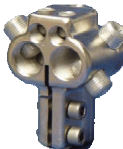
Zacisk TOGA 2: Mocowanie kabli poziome Zakres przekrojów przewodów głównych : 50-185 mm 2 Zakres gwintów przepustu M12-M20
