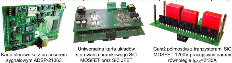
Rys. 10. Opracowany w Katedrze Automatyki Napędu Elektrycznego Politechniki Gdańskiej model laboratoryjny dwukierunkowego półmostkowego (DHB – Double Half Bridge) przekształtnika DC-DC z transformatorem planarnym 2kW
