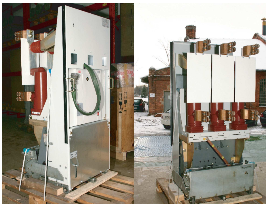
Rys. 5. Człon wysuwny rozdzielnicy ELMOBLOK z wyłącznikiem próżniowym
