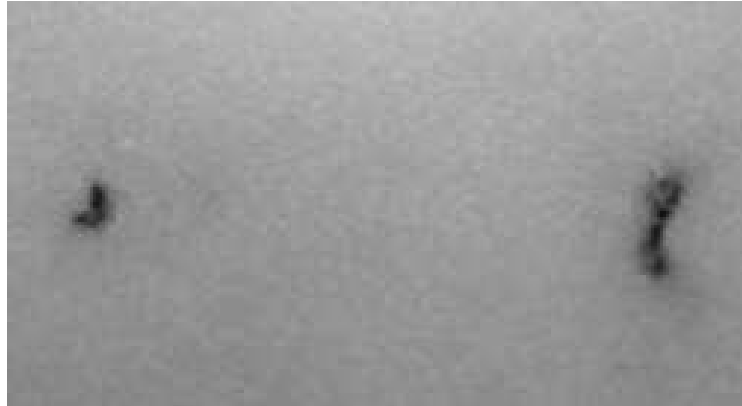
Rys. 5. Kompozyt PU zawierający 33% mączki kwarcowej po drugim stopniu próby odporności na łuk
