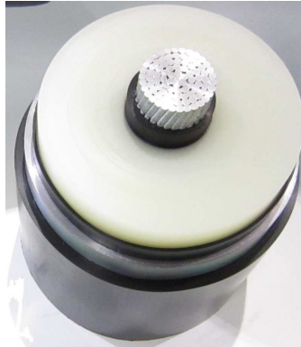
Rys. 1. Próbkę kabla XLPE, 800 kV, 630 mm 2 (fot. autorka)
