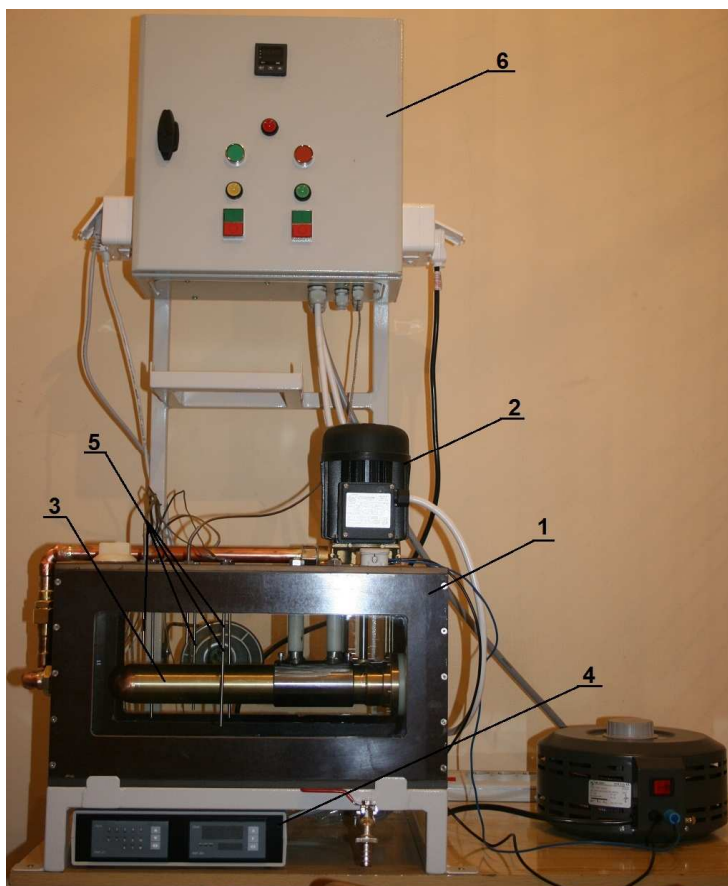
Rys. 2. Układ eksperymentalny do badania wpływu skoncentrowanego strumienia ciepłego na parametry dielektryczne estru syntetycznego: 1 - zbiornik pomiarowy, 2 - pompa elektryczna wymuszająca obieg cieczy w układzie, 3 - grzałka, 4 - rejestrator temperatury, 5 - zestaw czujników temperatury typu Pt-100, 6 - szafa sterowniczo-pomiarowa
