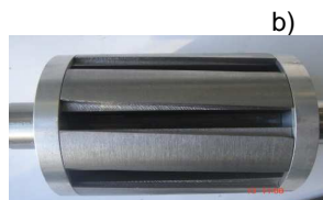
Rys.9 Wirnik zbudowanego prototypu G-1 a) schemat poglądowy b) koncentraty z koszem
