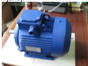
Rys. 8 Widok i stojan silnika asynchronicznego produkcji ukraińskiej typu AIR90L8
