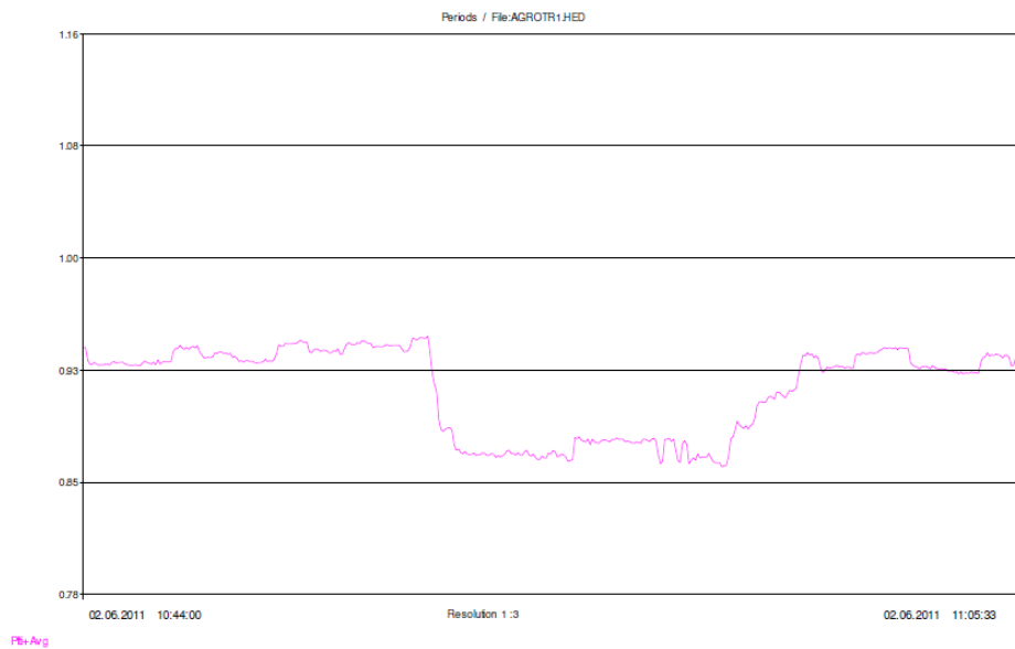
Rys. 8. Współczynnik mocy \cos\varphi średni dla trzech faz zasilających Źródło: na podstawie badań
