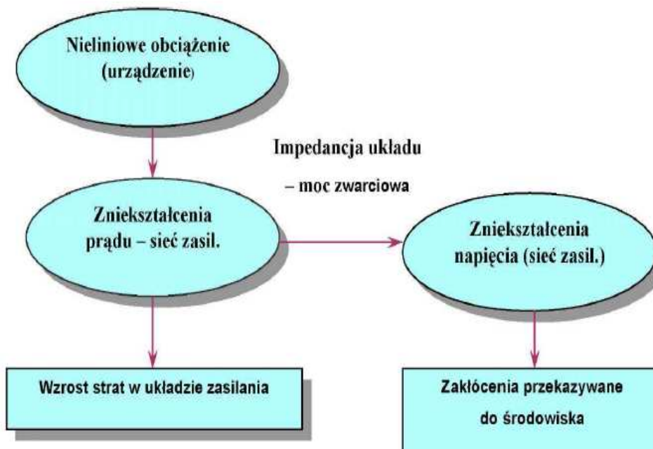
Rys. 1. Odbiornik nieliniowy jako źródło zniekształceń harmonicznych prądu powodujące odkształcenia przebiegu napięcia zasilającego Źródło: na podstawie [3]
