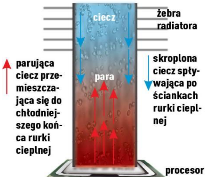
Rys. 4. Zasada działania rurki cieplnej [11].
