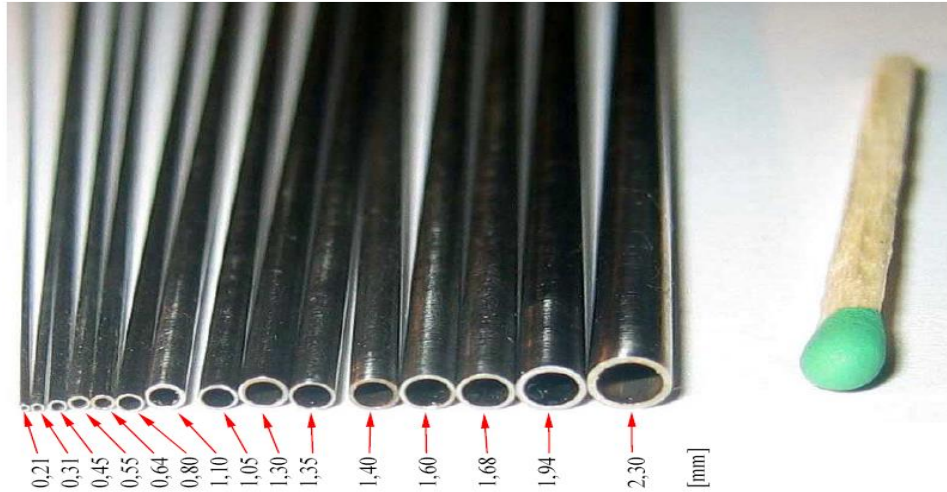
Rys. 1. Widok minikanalów rurowych stosowanych w badaniach eksperymentalnych [3].
