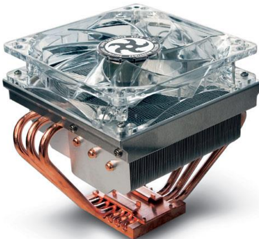
Rys. 5. Przykładowy układ chłodniczy mający zastosowanie w układach elektronicznych, wykorzystujący procesy wrzenia i skraplania czynnika chłodniczego odbywającego się w rurkach cieplnych.
