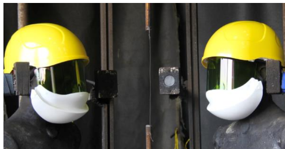
Rys. 6. Układ do badania odporności na łuk elektryczny, metoda ASTM F2178-12.
