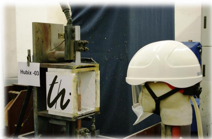
Rys. 1. Układ do badania odporności na łuk elektryczny, metoda BOX-TEST
