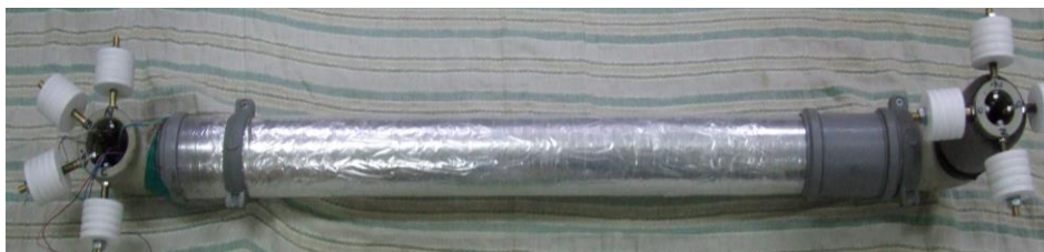
Rys. 2. Widok skonstruowanego modelu trójfazowego kablok wysokotemperaturowego z wysokonapięciowymi doprowadzeniami prądowymi.
