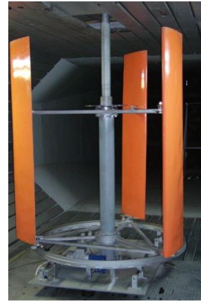
Rys. 4. Model doświadczalny perspektywicznej turbiny wiatrowej Darrieus'a z regulowanym kątem natarcia łopatek.
