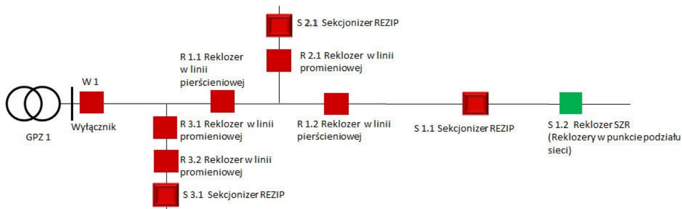
Rys. 2. Przykład rozmieszczenia reklozerek w sieci SN
