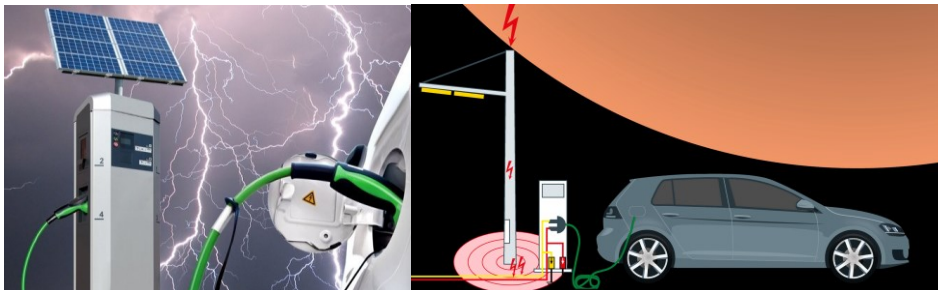
Rys.1. Ochrona stanowiska ładowania samochodów przed działaniem LEMP.
