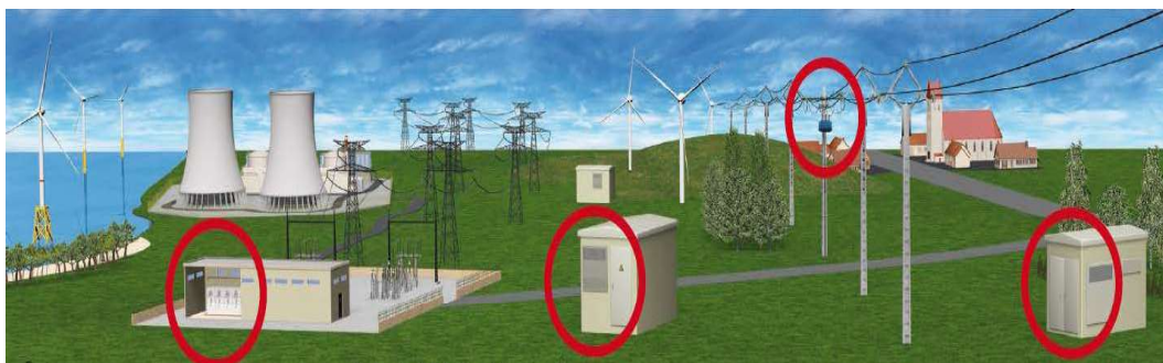
Fig.2. pomiar parametrów sieci kablowej w punktach rozgałęźnych
