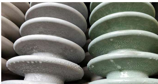
Rys.1. Izolatory SN wykonane z hydrofobowego materiału polimerobetonowego na bazie polimetakrylanu metylu.
